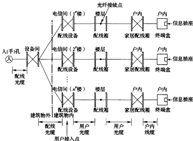
图 2 高层住宅建筑用户接入点位置示意
