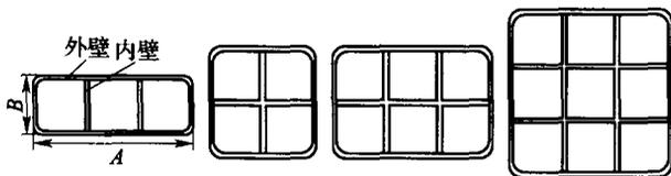
图5 栅格式塑料管横断面形式
