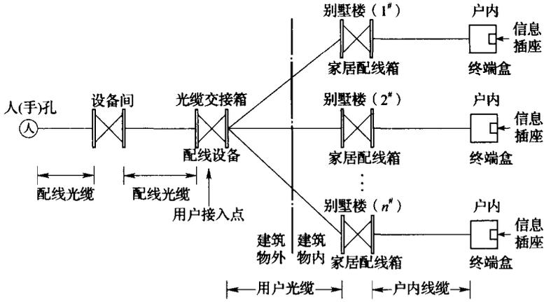
图 4 别墅建筑用户接入点设置示意
